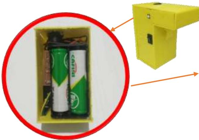
Las baterías recargables permiten alimentar el dispositivo el cual se aloja en una base, permitiendo la alimentación constante a un voltaje estable de cinco voltios a través de un regulador de voltaje.
