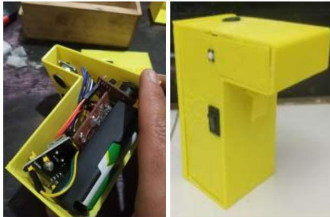
*Nota:* Ensamblado de los componentes electrónicos en el chasis y prototipo finalizado.
