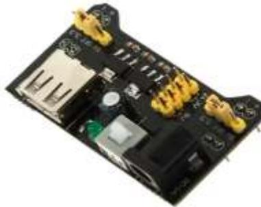
*Nota.* La Figura 16 muestra una fuente de alimentación regulable entre 5 o 3,3 voltios de FC Elektronik (2023).
