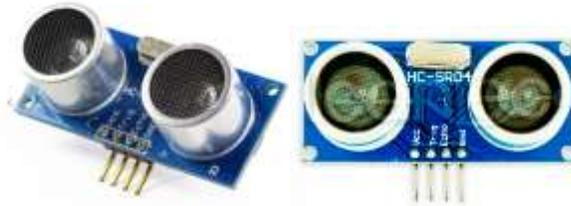
*Nota.* En la Figura 13 se muestra un sensor ultrasónico HC-SR04, por Datasheet HC-SR04 (2023). Fuente: <https://leantec.es>.
