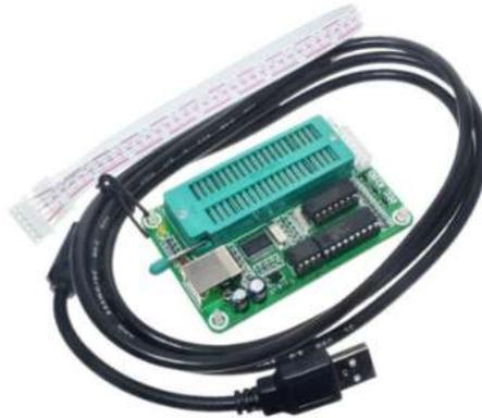
*Nota.* La Figura 12 muestra un programador de microcontroladores PIC el cual es compatible con PIC de ocho hasta 40 pines, por Electronilab (2023). Fuente: <https://electronilab.co/>.
