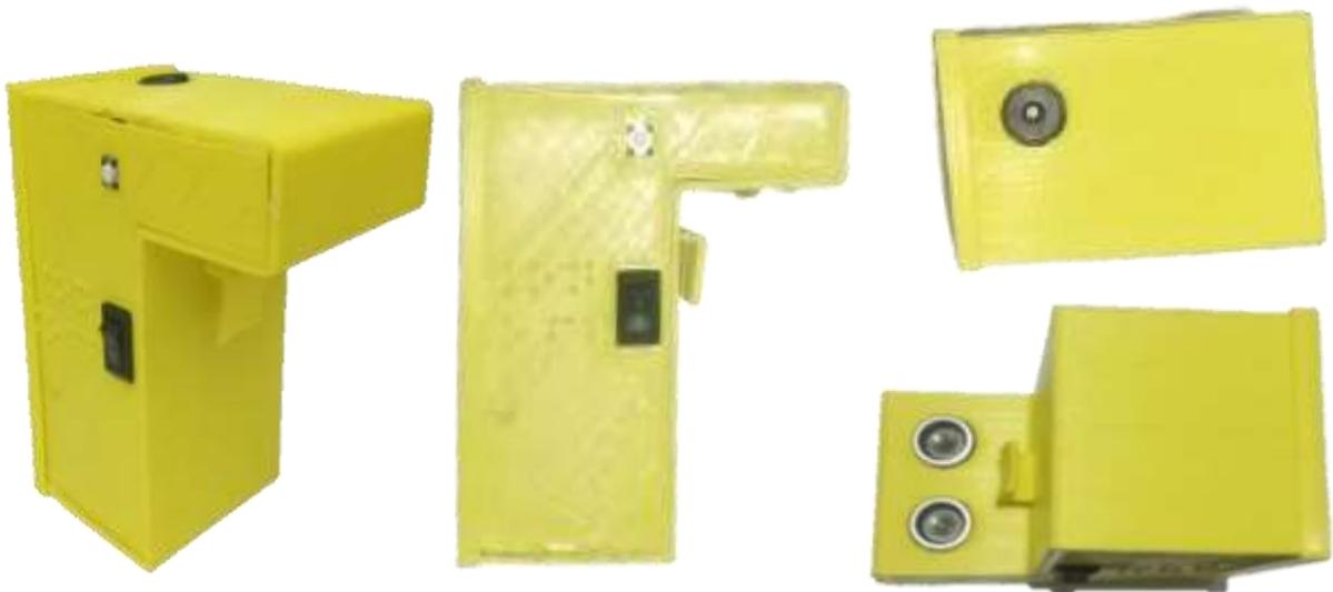
Este dispositivo se ha diseñado para ofrecer una repuesta sonora a la hora de verter líquido en un recipiente. Funciona con dos pilas recargables (li-ion) de 4.8 voltios, el cual es regulada a un voltaje estable de cinco voltios.
