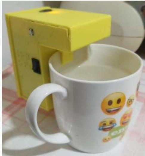
*Nota:* Funcionamiento del prototipo indicador del nivel de liquido
