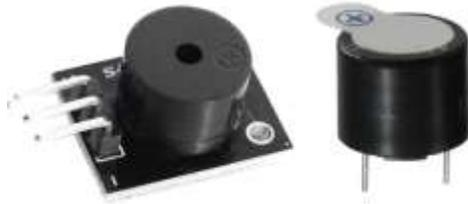
*Nota.* La Figura 15 muestra dos tipos de módulos Buzzer Pasivos de MV Electrónica (2018). Fuente: <https://mvelectronica.com>
