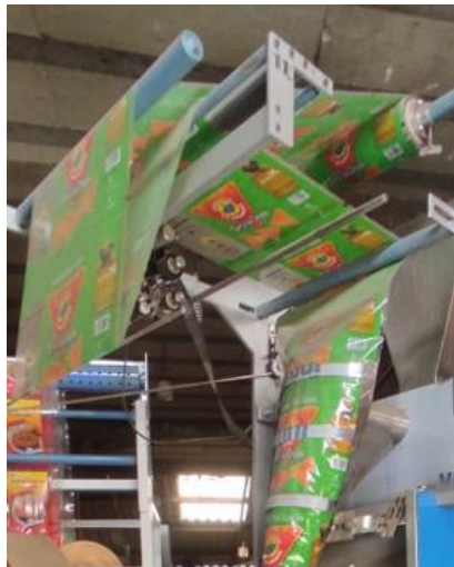
Figura 3. 4 BOBINA DE MAQUINARIA PARA DOSIFICACIÓN
