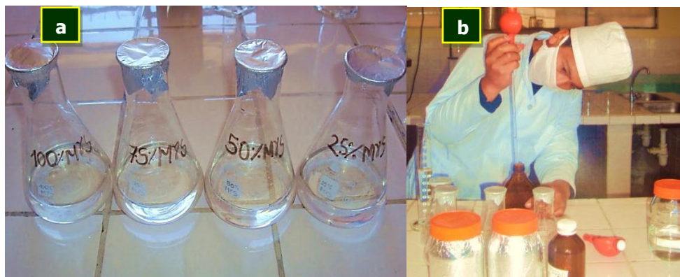
Figura 11. Preparación de medios de cultivo. Matraz erlenmeyer con la respectiva disolución de Sales MS (a) y Adición de las soluciones stock a los Matraces de preparación de medios de cultivo (b).
