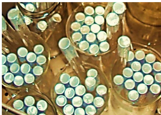
Figura 14. Sellado de tubos de ensayo para el autoclavado
