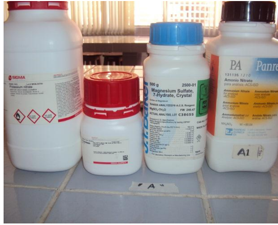
Foto 2. Solución A ( \text{KNO}_3 , \text{KH}_2\text{PO}_4 , \text{MgSO}_4 \cdot 7\text{H}_2\text{O} , \text{NH}_4\text{NO}_3 )
