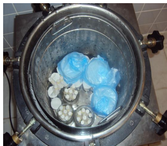
Foto 8. Esterilización de tubos de ensayo con medio cultivo, cajas petri, pinzas bayonetas.
