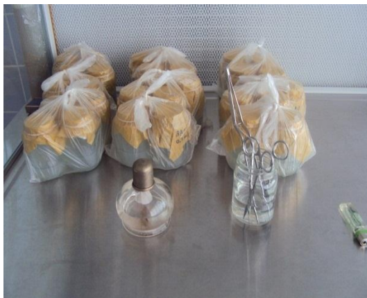
Foto 1. Frascos con medio basal WPM (1980), mechero, pinza bayoneta, tijera
