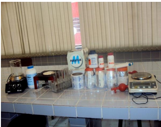
Foto 1. Agitador magnético, hornilla eléctrica, balanza, medidor de pH, vaso precipitado, tubos de ensayo, medios basales, agar agar, azúcar.
