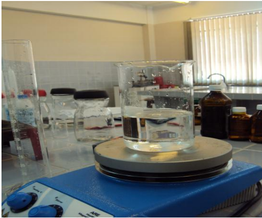
Foto 3. Dilución de los medios basales en el agitador magnético
