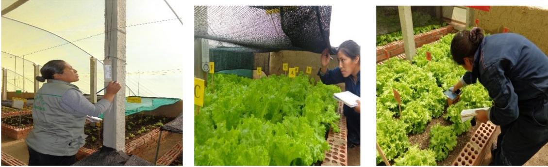
**Foto 8.** Toma de datos, en temperatura, humedad relativa y densidad de luz
