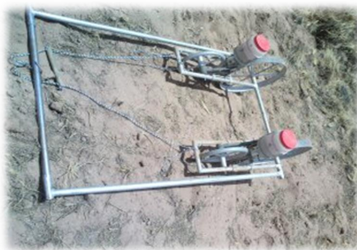
Foto 12. Sembradora de cañahua modelo Tipi Top.
