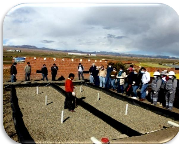
Figura 15. Estanques artificiales de ensayo en pleno funcionamiento
