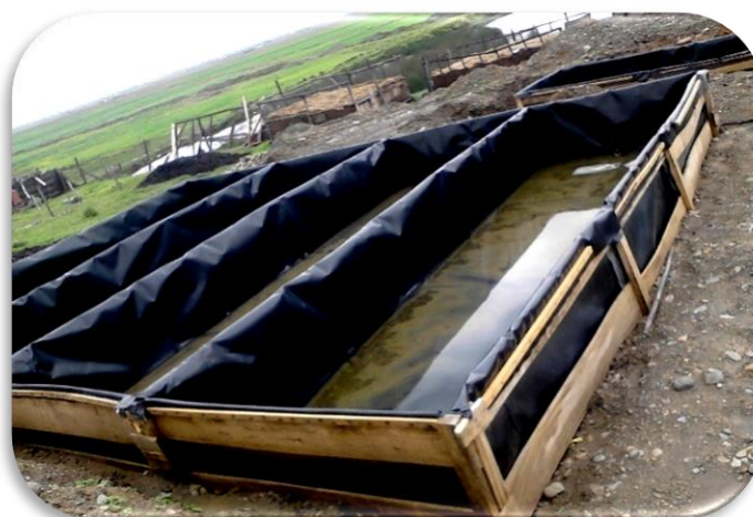
Figura 4. Estanques artificiales de ensayo recubiertos con la geomembrana
