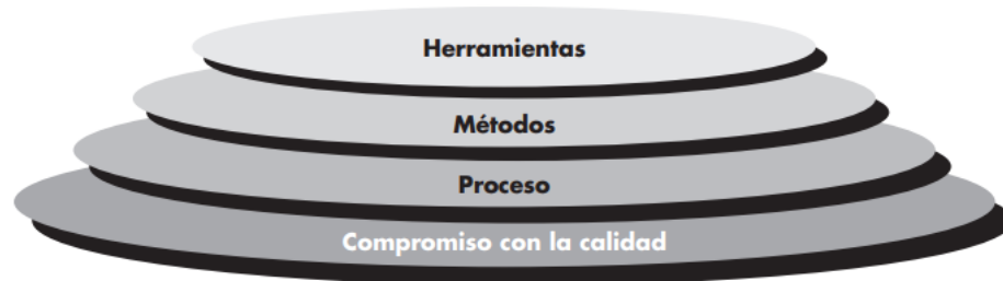
Figura 2. 12 Capas de la Ingeniería de Software (Pressman, 2002)
