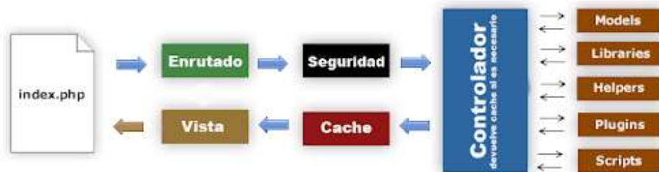
Figura N° 2.10. Diagrama de Flujo de CodeIgniter
