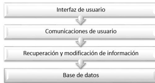
Figura 3 Modelo por capas de un Sistema de Información
