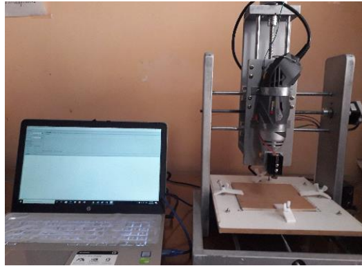
Figura 7. Conexión del CNC a la computadora para el Tallado
