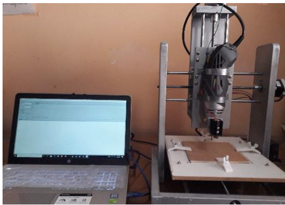
Figura 3.51. Conexión del CNC a la computadora, para realizar el tallado
