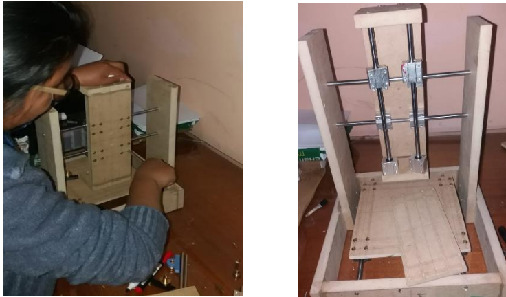
Figura 3.25. Armado del CNC
