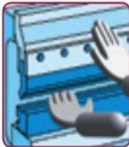
Pinchazo, perforación, cizallamiento, amputación, corte
