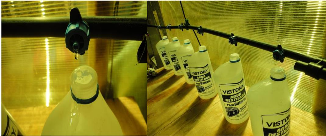
Figura 3. 20: Prueba de capacidad de goteros.
