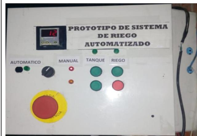
Gabinete parte frontal del prototipo de sistema de riego automatizado. Código de colores según IEC 73.
