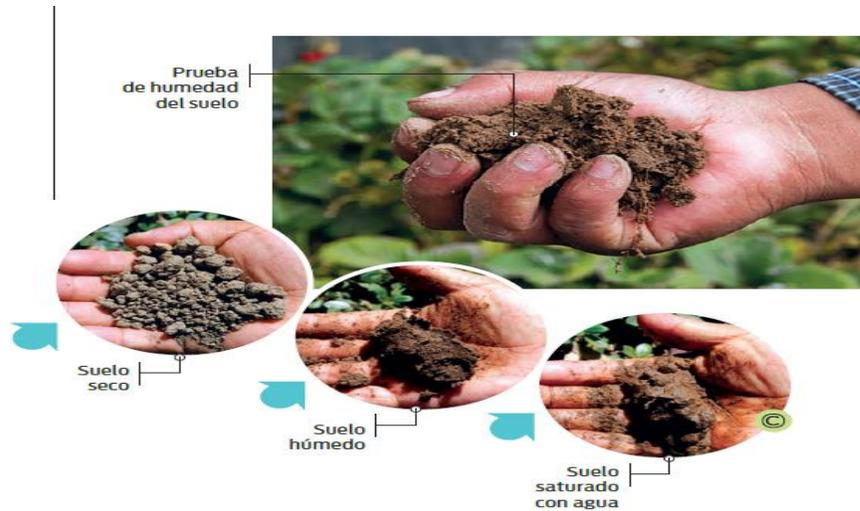
Figura 3. 22: Pruebas de humedad mediante el tacto y la apariencia (Bolda & Dara, 2015)
