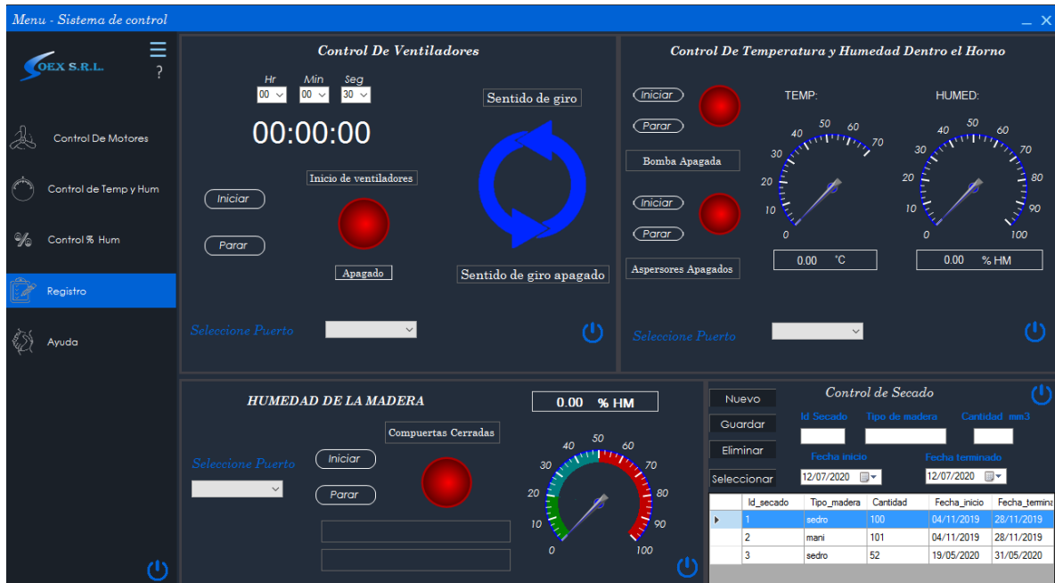
Figura 3. 38: vista del control total se sistema de control HMI
