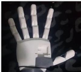
Se puede ver la impresión de la palma con el armado de las falanges que son los dedos del prototipo. En el espacio vacío que se observa en esa parte entra lo que es un servo motor.
