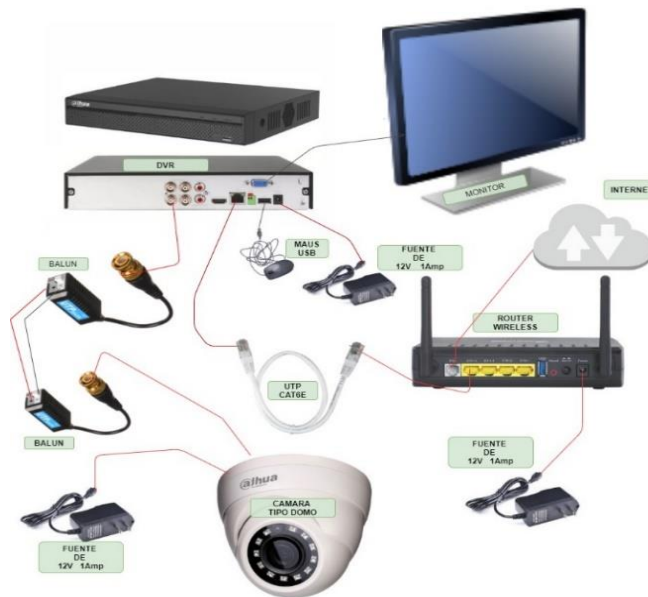
Figura N° 16. Sistema de CCTV
