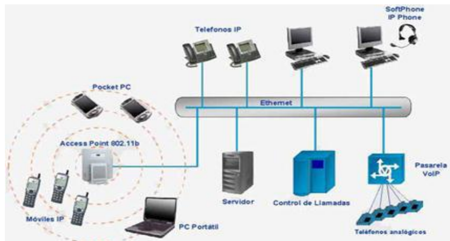
Figura N° 23. Estructura interna de telefonía IP de una empresa
