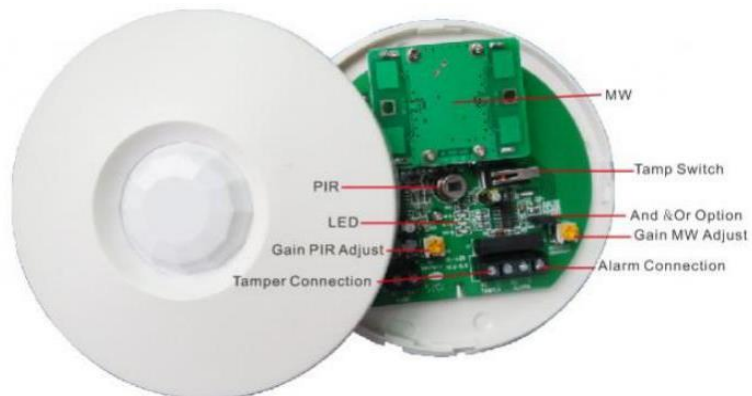
Figura N° 11. Partes internas de un sensor de movimiento de 360 grados
