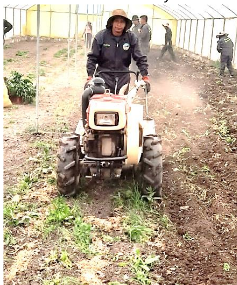
Figura 3. Desterronado del suelo con motocultor
