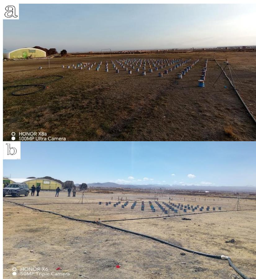
**Figura 12. Instalación de la red de tuberías y pluviómetros**
