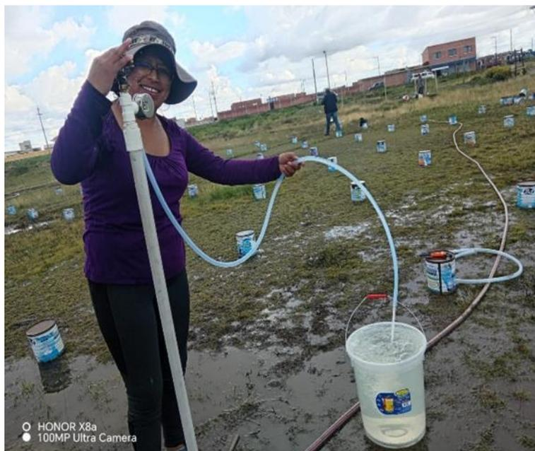
**Figura 16. Evaluación del caudal por el método volumétrico**
