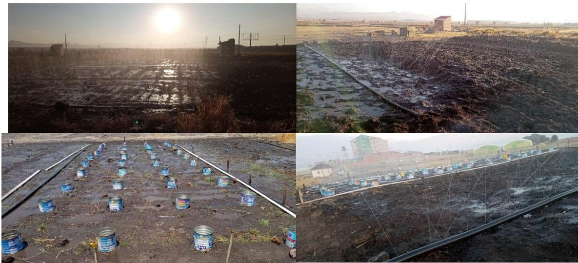
**Anexo 28. Medición del caudal desfogado (l/min) en las cintas Golden Spray**
