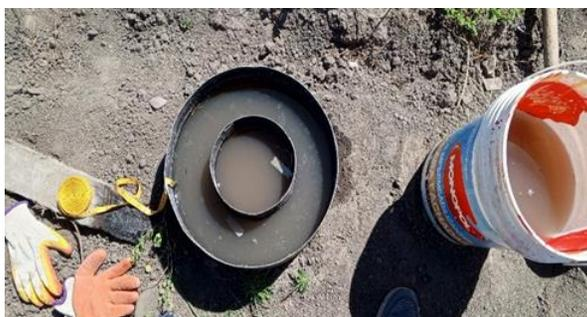
**Figura 6. Prueba de infiltración, por el método de doble cilindro**
