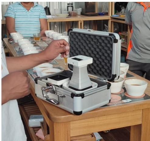
**Figura 4.** Medición de humedad de los granos de café
