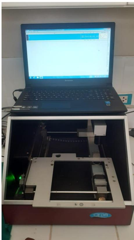
**Figura 5. Analizador Óptico del Diámetro de Fibra 2000**
