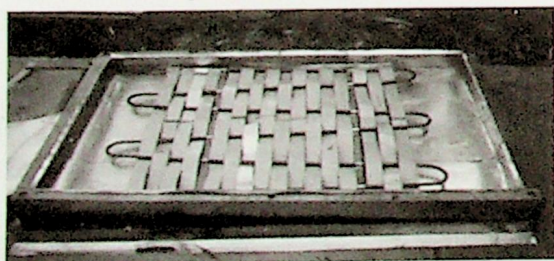
Fotografía 2. Tubos de desagüe con botellas cerveceras para colector solar plano. Construida por el autor. (Fuente propia)
