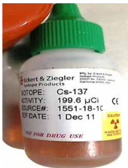
Figura 1. Fuente cerrada, líquida, certificada de Cesio 137, 199 µCi al 1/12/2011.
