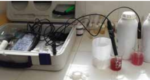
Ilustración 4. Medición de pH y conductividad en laboratorio.
