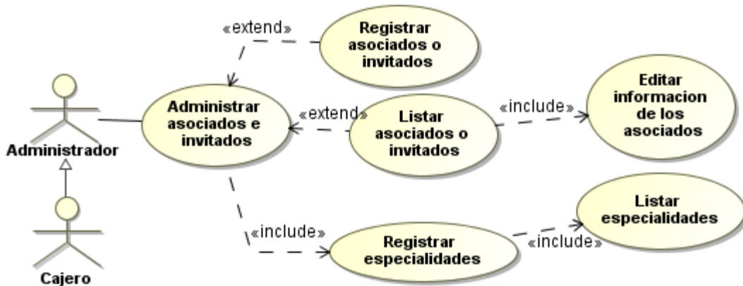
Figura No. 17. Diagrama de Caso de Uso de Administrar Asociados e Invitados
