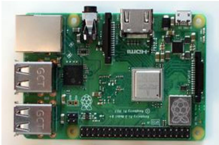
**Fig. 23 Raspberry Pi 3 Model B+**
