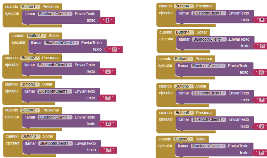
Figura N° 19 Diagrama de bloque de botones de desplazamiento
