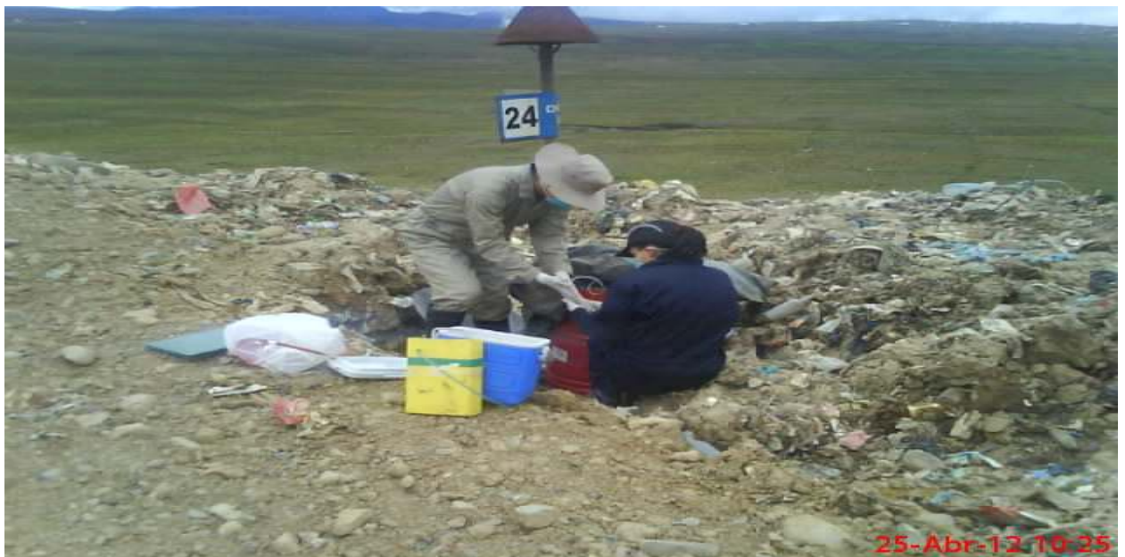
Cahuasa, Simón; los técnicos de (IIDEPROQ) realizan muestreo de biogás en chimenea para monitorio ambiental, fotografía 25 de Abril de 2012.
