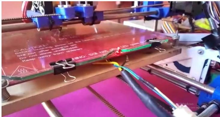
**Figura 3.6 montaje de la base caliente**
