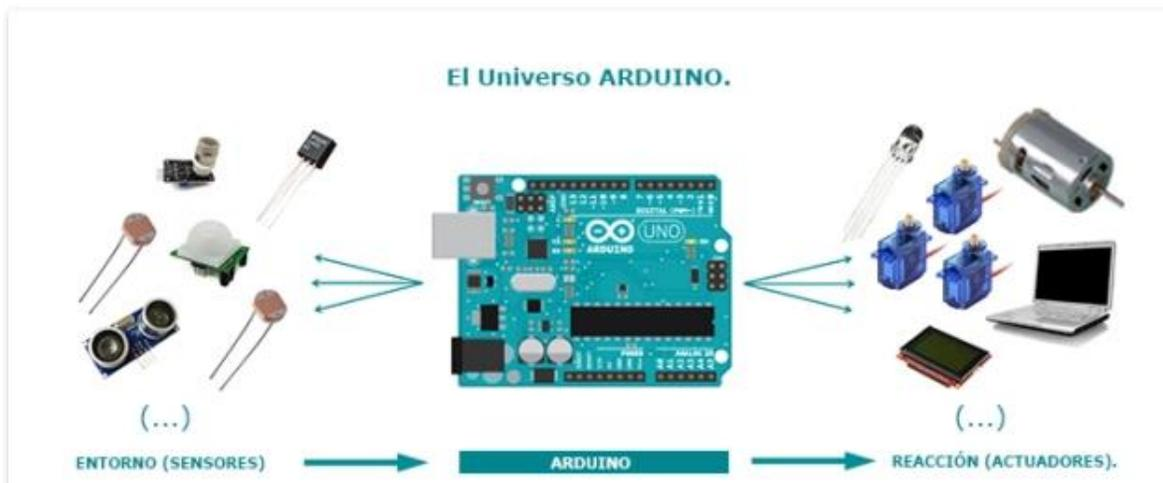
**Figura 2.3 Ilustración de la placa Arduino y sensores**
