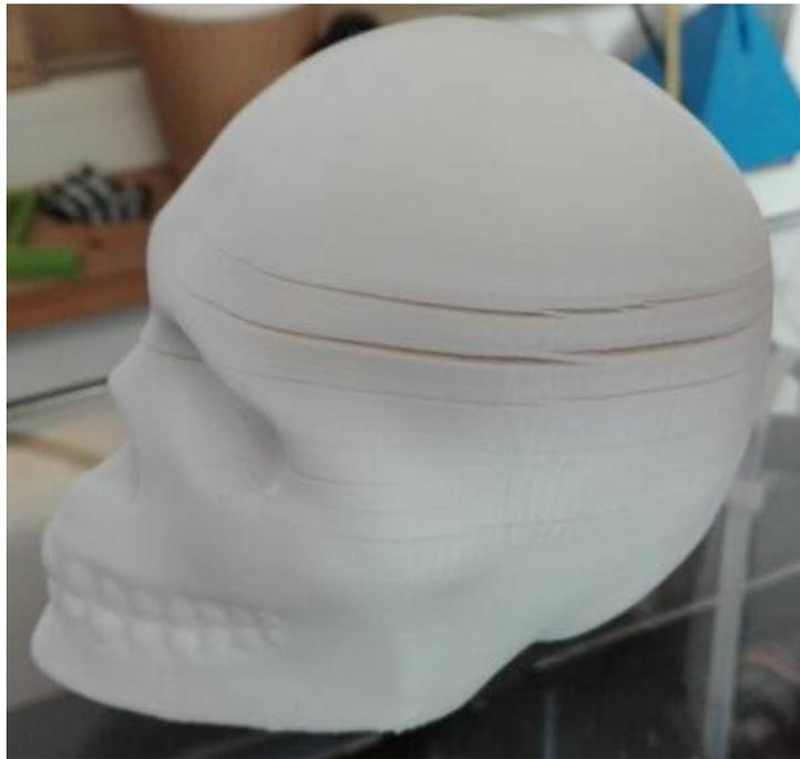
**Figura 2.15 Efectos de la delaminación**
