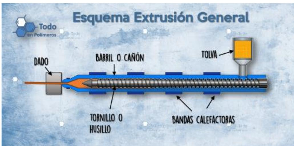
**Figura 2.14 Esquema de Extrusión**
