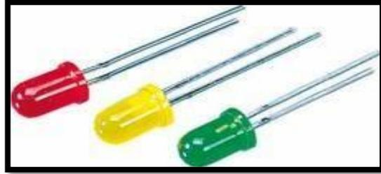
**Nota:** Diodos led de diferentes colores (Electrónica Joan,2014)
