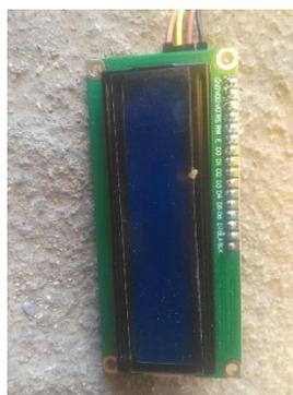
**Nota:** pines del LCD para el conexionado en Arduino
