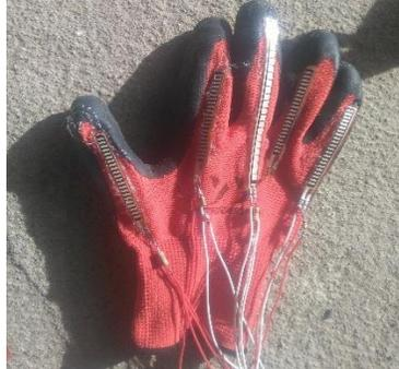
**Nota:** Sensores flex en el guante con sus conexiones.
