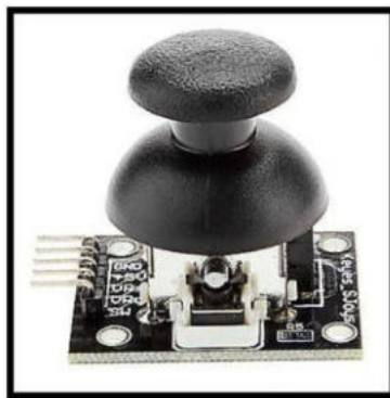
Figura 3.9 Joystick KY023 Fuente: Elaboración propia
