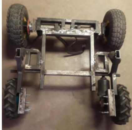
Figura 4.2 Estructura base modulo físico
