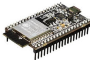
Figura 3.14 Microcontrolador ESP32 Fuente: Elaboración propia
